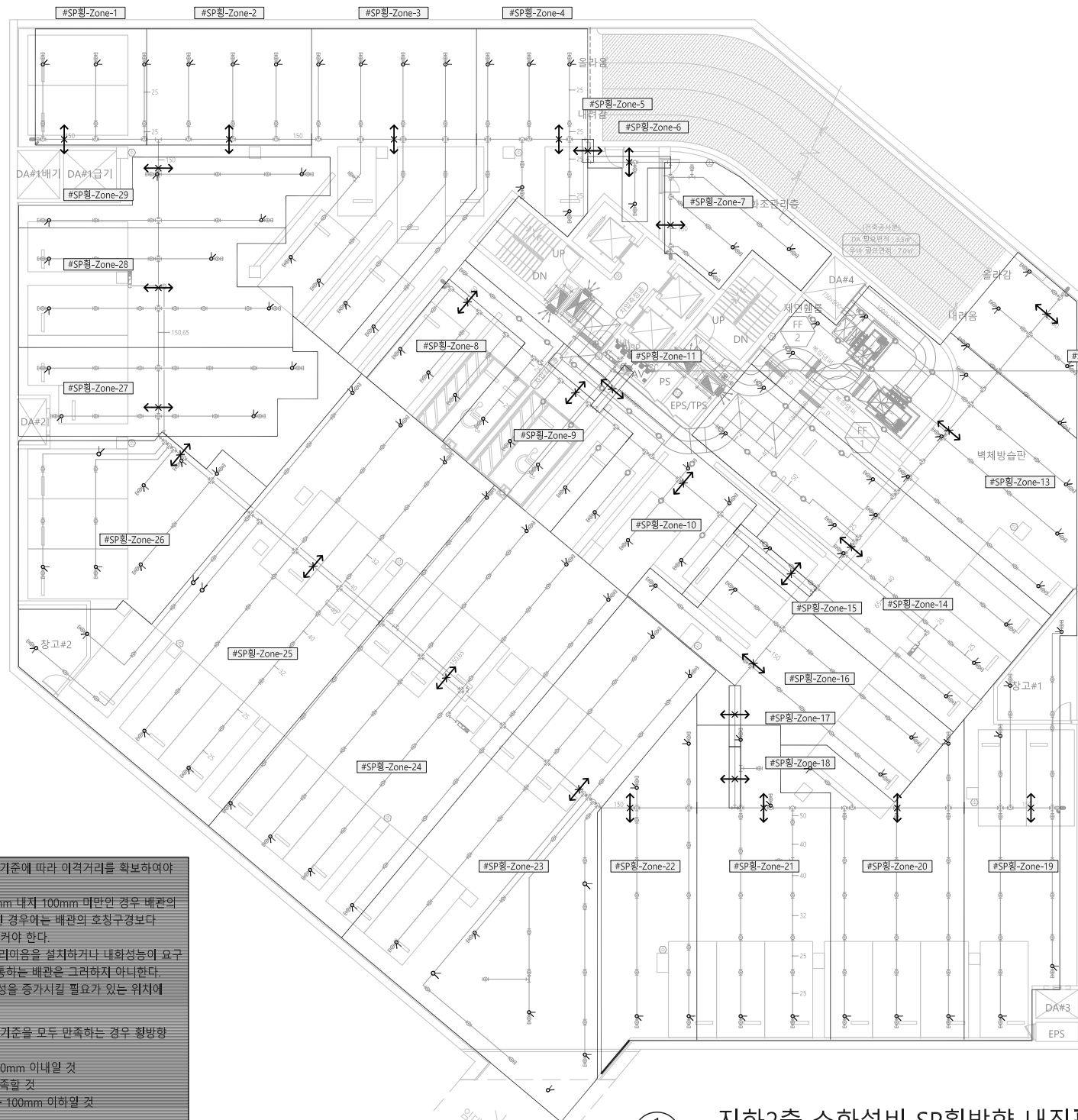
1 지하2층 소화설비 SP횡방향 내진평면도 축척 A3:1/300(A1:1/150)
